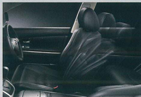
マルチアジャスタブルパワーシート (運転席8ウェイ・助手席4ウェイ)
