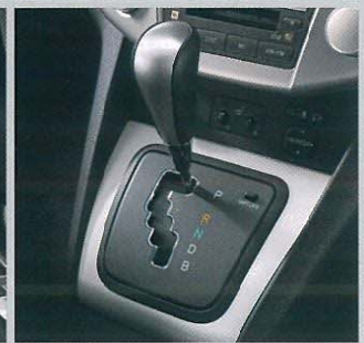
ゲート式シフトレバー&本革巻きシフトノブ (本アルミ加飾)
