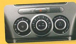
オートエアコン& ダイヤル式ヒーターコントロールパネル
