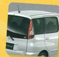
プライバシーガラス (リヤドア、リヤクォーター、バックドア)
