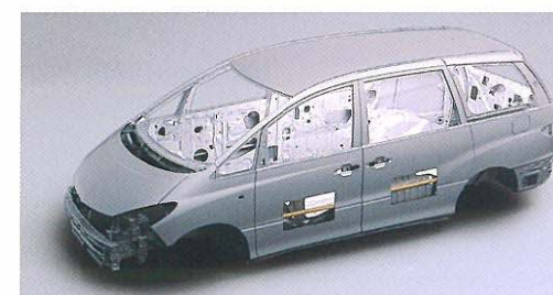
衝撃吸収ボディ&高強度キャビン“GOA” ●サイドエアビームは機能説明のために着色したものです。
