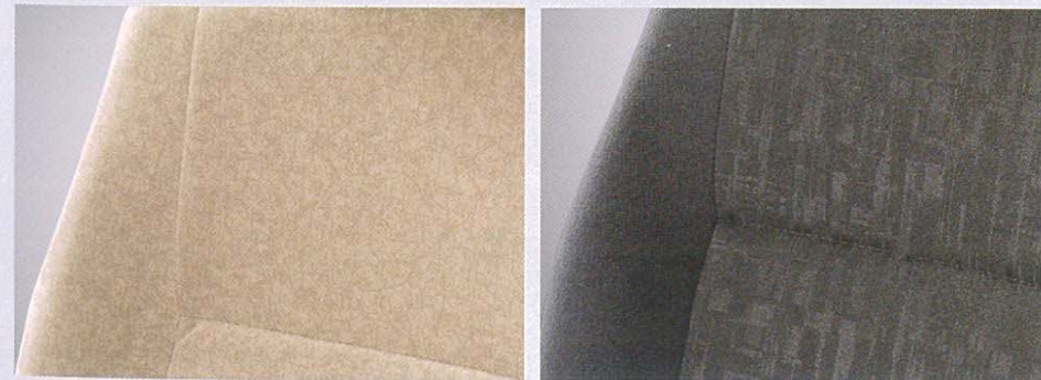
d) トリコットニット(アイボリー) e) ジャカード織物(ダークグレー)
