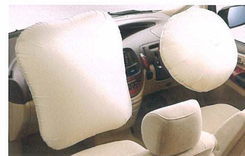
デュアルSRSエアバッグ ●写真は機能説明のためにSRSエアバッグが作動した状態を再現したものです。
