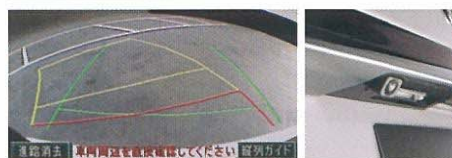
カラーバックガイドモニター表示画面 カラーバックガイドモニターカメラ部 (バックドアガーニッシュ下側)
