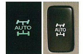
4WDオートモード インジケータ 4WDオートモード スイッチ
