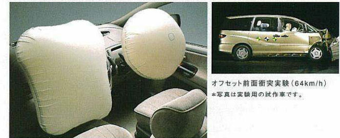
デュアルSRSエアバッグ *写真は機能説明のためにSRSエアバッグが作動した状態を再現したものです。
