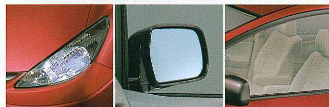
マルチフレクターディスチャージヘッドランプ(ロービーム・レベリング機能付) | レインクリアリングドアミラー(ブルーミラー) | 撥水機能付フロントドアガラス(ロービーム・レベリング機能付)
