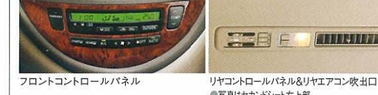
フロントコントロールパネル リヤコントロールパネル&リヤエアコン吹出口 ●写真はセカンドシート右上部 ●ツインムーンルーフを選択した場合、リヤコントロールパネルは天井に装着されます。
