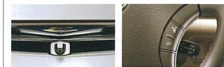
ブラインドコーナーモニターカメラ部 ブラインドコーナーモニタースイッチ (フロントグリル) ●エアラス-Sのブラインドコーナーモニタースイッチはインパネに装着されます。
