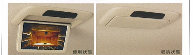
後席9型液晶ワイドディスプレイ ●ディスプレイの開閉は手動となります。
