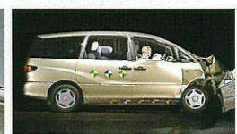
オフセット前面衝突試験 (64km/h) *写真は実験用の試作車です。
