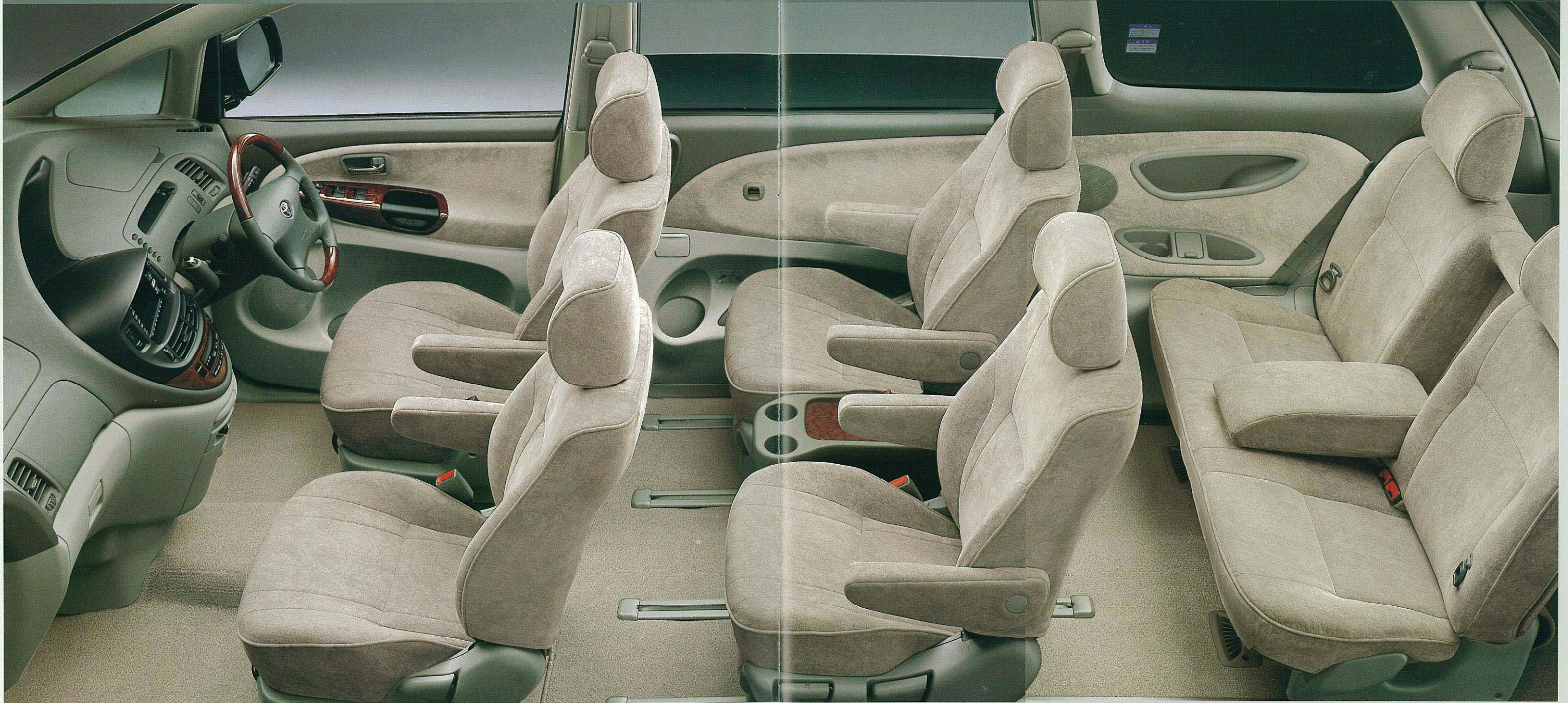
Photo: G (3.0L/7人乗り) 2WDの室内。内装色はミディアムチャコール。レーダークルーズコントロール、クリアランスソナー&バックソナーはメーカーオプション。DVDボイスナビゲーション付ワイドマルチAVステーションとバックガイドモニターとガラスアンテナ(ダイバシティ・TV付)はセットでメーカーオプション。
