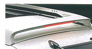
ルーフレール一体式LEDハイマウントストップランプ付リヤスポイラー (アエラスに標準装備、Gにメーカーオプション)
