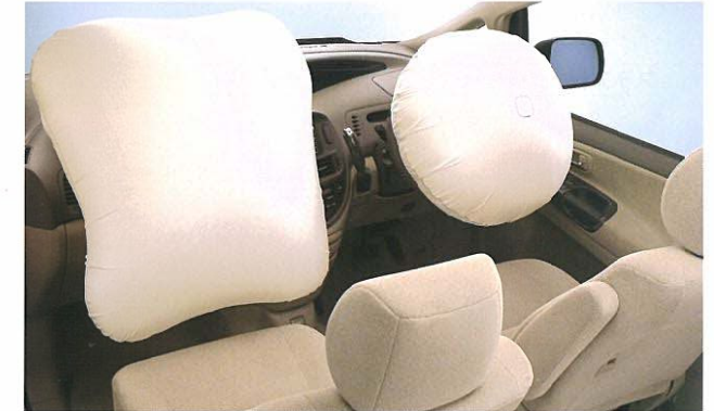
デュアルSRSエアバッグ ●写真は機能説明のためにSRSエアバッグが作動した状態を再現したものです。
