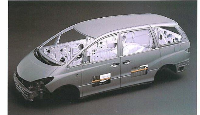
衝撃吸収ボディ&高強度キャビン "GOA" ※1 ●サイドドアピラーは機能説明のために着色したものです。
