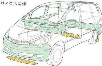
TSOP使用部位 (TSOP:Toyota Super Clefin Polymer)
