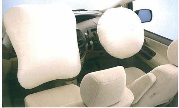
デュアルSRSエアバッグ ●写真は機能説明のためにSRSエアバッグが作動した状態を再現したものです。
