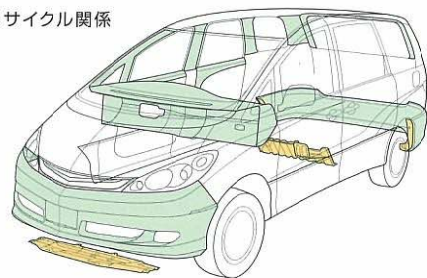
TSOP使用部位 (TSOP: Toyota Super Olefin Polymer) リサイクルPP使用部位 (PP: Polypropylene)
