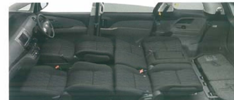
フロントシート・セカンドシートフラットモード(サードシート床下格納)
