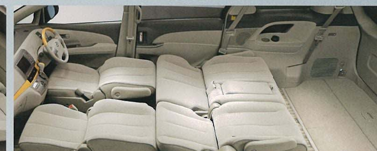
■フロントシート・セカンドシートフラットモード(サードシート床下格納)
