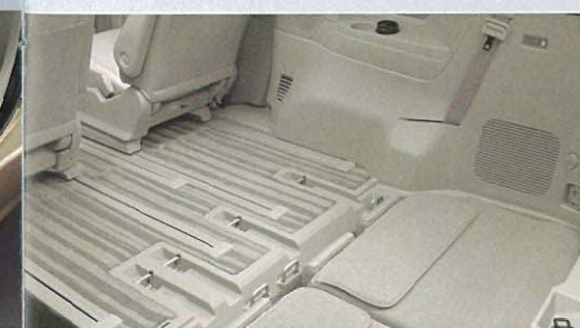
6:4分割・電動床下格納機能付サードシート
