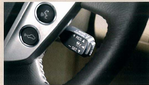
クルーズコントロールスイッチ 車間距離切替スイッチ
