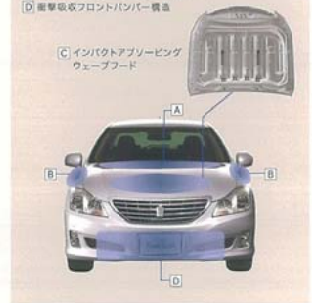
歩行者傷害軽減に配慮したボディ構造説明イラスト
