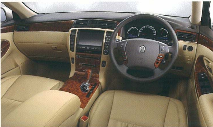
Photo:3.0ロイヤルサルーンGの運転席。内装色はアイボリー。レーダークルーズコントロール、音声ガイドシステム機能付カラーバックガイドモニター&クリアランスソナー、ナイトビュー、クラウン「マークレブソン」プレミアムサウンドシステム<G-800K対応高精細DVDボイスナビゲーション付EMV>、マイコン制御シフト&スライド電動ムーンルーフはメーカーオプション。本革シートとシートヒーターはセットでメーカーオプション。
