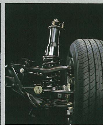
4輪ダブルウィッシュボーンサスペンション(リヤ)
