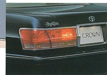
リヤフォグランプ※リヤフォグランプを装着した場合、テールランプの点灯状態が変わります。
