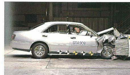
オフセット前面衝突実験(64km/h、写真は実験用試作車です。)
