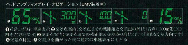
ヘッドアップディスプレイ・ナビゲーション (EMV装着車) ①通常走行時:車速表示 ②交差点案内:交差点までの残距離と交差点の形状(音声) [300m先〇〇町を左方向です] ③交差点案内:交差点までの残距離と交差点の形状(音声) [まもなく左方向です] ④交差点付近 ⑤交差点を曲がった後に通常の車速表示にもどる
