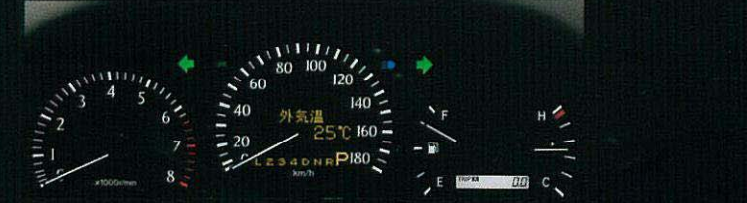
デュアルビジョンオプティロンメーター (デジタルモード)
