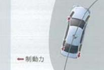
コーナリング中に前輪の横滑りが発生すると、ステアリングギヤ比を大きくすると同時に、操舵力を重くしてドライバーの過度の切り込み防止を促します。
