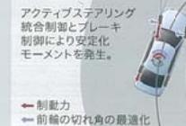
コーナリング中にリヤの横滑りを感じると同時に、クルマが自動でステアリング操作を修正し、スピン防止に貢献します。
