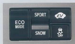
\*1. エンジン水温、バッテリーの充電状態、車速などの条件によりEVドライブモードにできない場合があります。 \*2. 状況によりエンジンが作動している場合があります。
