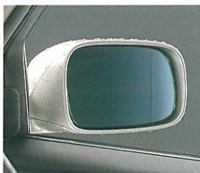
ヒーター付レインクリアリングミラー （ワイドビュー・ブルーミラー）
