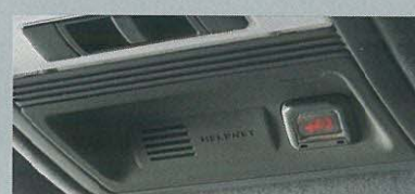
緊急通報システム“ヘルプネット”対応ユニット(エアバッグ連動タイプ)
