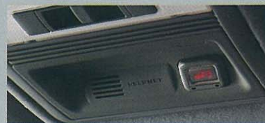
緊急通報システム“ヘルプネット”対応ユニット(エアバッグ運動タイプ)
