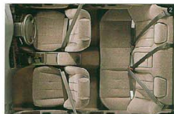
●写真は機能説明のためにすべてのSRSエアバッグが作動した状態をイメージしたものです。なお、SRSサイドエアバッグは、実際の衝突時には衝突側のみ膨らみます。
