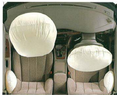
●写真は機能説明のためにすべてのSRSエアバッグが作動した状態をイメージしたものです。なお、SRSサイドエアバッグは、実際の衝突時には衝突側のみ膨らみます。
