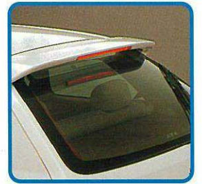
LED式ハイマウントストップランプ付リヤスポイラー(ガラス面に水滴などが付着しにくいエアフロー効果付)
