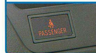
運転席・助手席シートベルト非着用警告灯 (点滅式) 写真は助手席。
