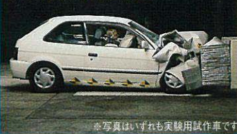
オフセット前面衝突実験 (60km/h) *
