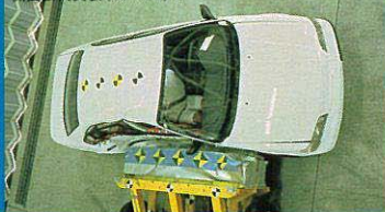
側面衝突実験 (54km/h) *
