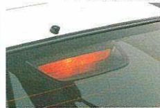
バルブ式ハイマウントストップランプ(室内装着タイプ)
