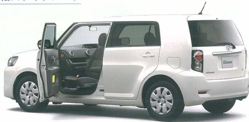
Photo:カローラ ルミオン 1.5G (2WD) 助手席回転スライドシート車「Aタイプ」。ボディカラーのホワイトパールクリスタルシャイン(070)はメーカーオプション。
