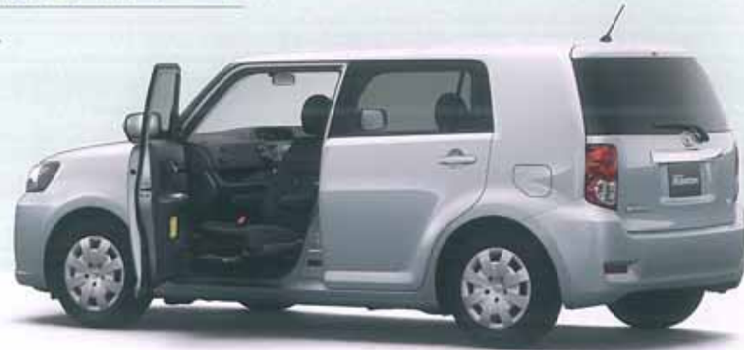
Photo:カローラ ルミオン 1.5G (2WD) 助手席回転スライドシート車*8タイプ。 ボディカラーはシルバーメタリック(1F)。 オプション装着車。
