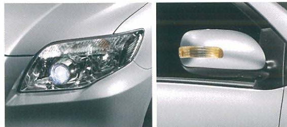
プロジェクター式ディスチャージヘッドランプ サイターンランプ付電動格納式リモコンカラードアミラー
