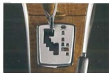
ゲート式シフトレバー (7速スポーツシーケンシャルシフトマチック)
