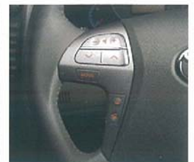
ステアリングスイッチ(HDDナビゲーションシステム装着時)
