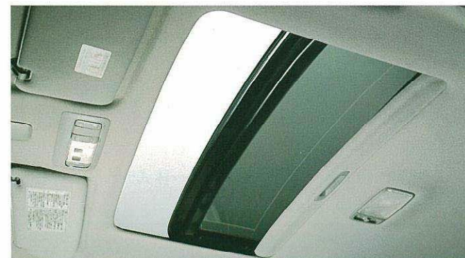
マイコン制御チルト&スライド電動ムーンルーフ(ワンタッチ開閉・挟み込み防止機構付)
