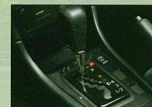
ゲート式A/Tシフトレバー (オートマチック車) ※写真は2.5ツアラーS用<5 Super ECT>。
