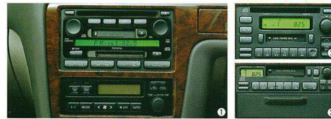
①カセット一体AM/FMマルチ電子チューナーラジオ&MD/CDプレーヤー+6スピーカー(チェイサー・ライブサウンドシステム)②カセット一体AM/FMマルチ電子チューナーラジオ&CDプレーヤー+6スピーカー(チェイサー・ライブサウンドシステム)③カセット一体AM/FMマルチ電子チューナーラジオ+4スピーカー
