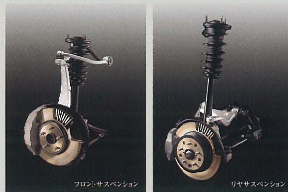
Photo: ニーロチューンド・サスペンション。(写真は機能説明のためにディスクの一部を切断了したカットモデルです)
