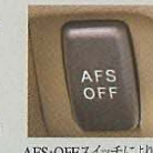
AFS-OFFスイッチにより作動・非作動を選択できます。
