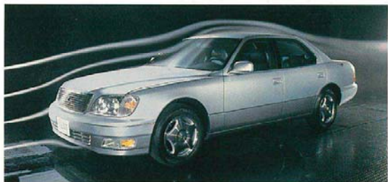
空力デザインのための風洞実験
