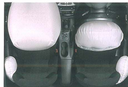
SRSエアバッグ&SRSサイドエアバッグ(運転席・助手席) ●写真は機能説明のためにすべてのSRSエアバッグが作動した状態を再現したものです。なお、SRSサイドエアバッグは、実際の衝突時には衝突側のみ膨らみます。
