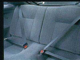
リヤELR付3点式シートベルト (チャイルドシート固定機構付)
