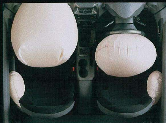
デュアルSRSエアバッグ(運転席・助手席SRSエアバッグ) & SRSサイドエアバッグ ●写真は機能説明のためにすべてのSRSエアバッグが作動した状態を再現したものです。 なお、SRSサイドエアバッグは、実際の衝突時には衝突側のみ膨らみます。
