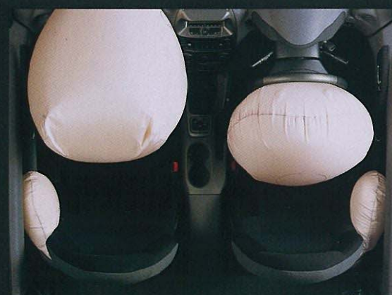
デュアルSRSエアバッグ(運転席・助手席SRSエアバッグ)&SRSサイドエアバッグ ●写真は機能説明のためにすべてのSRSエアバッグが作動した状態を再現したものです。 なお、SRSサイドエアバッグは、実際の衝突時には衝突側のみ作動します。
