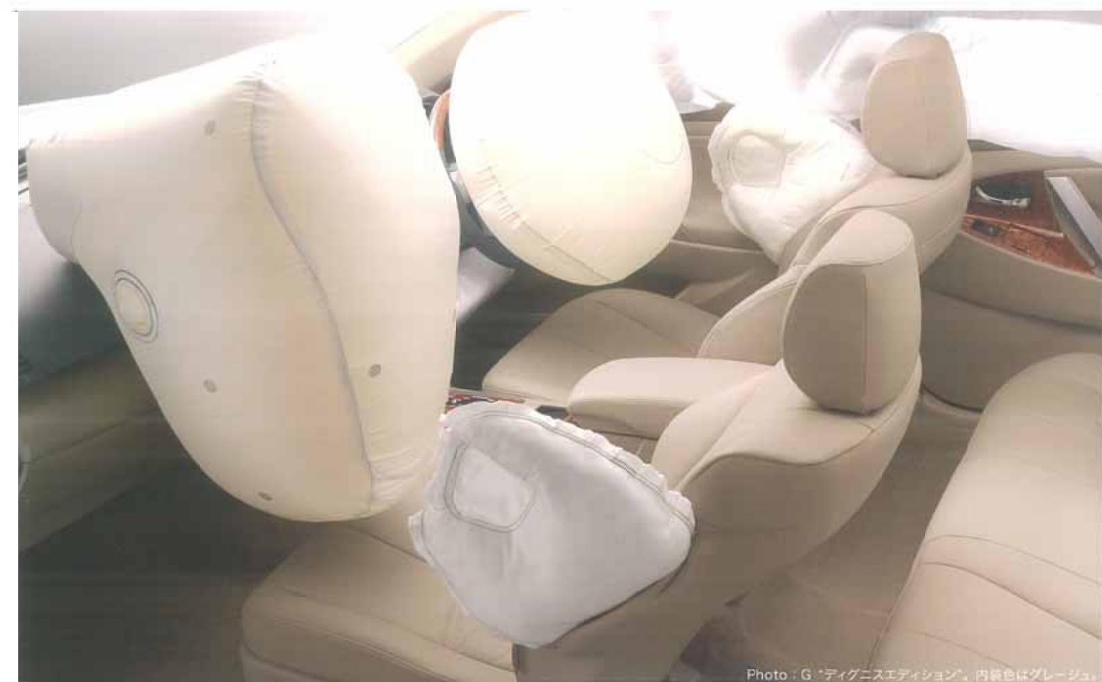
Photo: G「ティグニスエディション」。内装色はグレーージュ。■写真は機能説明のためにボディの一部を切断したカットモデルです。
