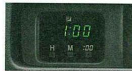
■デジタル時計 (電波時計・メーター一体式) デジタル時計には、JJY (標準電波送信所) から送信される電波を受信することで、時刻を自動修正する電波時計を採用。(自動車搭載では世界初)
