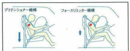
■プリテンショナー\*5&フォースリミッター付シートベルト 前面衝突時に強い衝撃を感知すると、瞬時にシートベルトを巻き込み拘束効果を高めるプリテンショナー機構、そしてシートベルトに一定以上の荷重がかからないようにすることで、胸部の衝撃を緩和するフォースリミッター機構を採用した。
