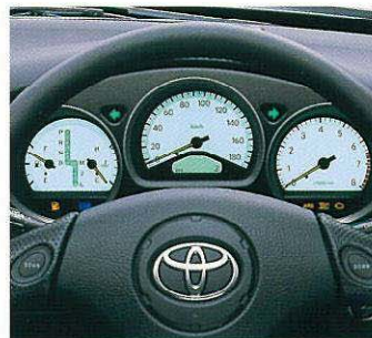
⑩オプテイトロンメーター 独立3期式ホワイトフェイス。文字画面を発光させ、文字や指針、目盛をシルエット表示します。直射日光下での視認性にも優れています。 *写真の計器盤は機能説明のため各ランプを点灯させたものです。
