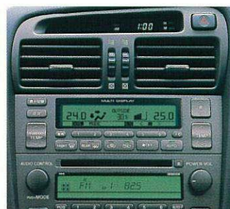
⑯左右独立温度コントロールマイコンオートエアコン 運転席側・助手席側でそれぞれ独自の温度設定が可能です。またセンサーからの日射量情報をもとに、きめ細かな室温のコントロールを行います。 *画面はハメ込み合成です。
