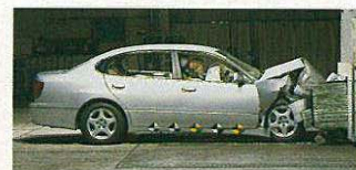
オフセット前面衝突実験(60km/h、写真は実験用の試作車です。)
