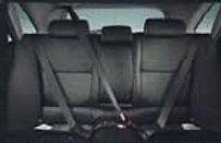
天井格納式リヤELR付3点式シートベルト(中央席)
