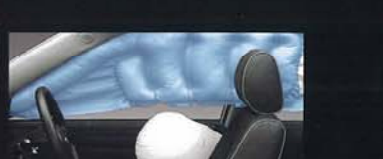
SRSサイドエアバッグ+カーテンシールドエアバッグ(運転席・助手席)
