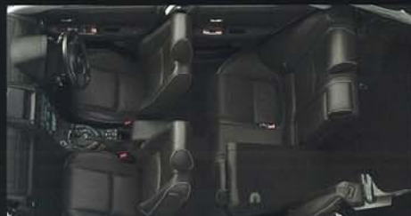
リヤシート片側前倒し状態＋フラットデッキボード（高床状態）
