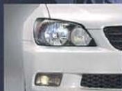
オートレベリング機能付フォースターヘッドランプ(ロービーム)/フロントプロジェクトワンプラン(イエロー)
