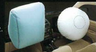
デュアルSRSエアバッグ (運転席・助手席SRSエアバッグ)
