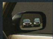
電動格納式リモコンカー・ドアミラー (ヒーター付・運転席側ワイドビュー)
