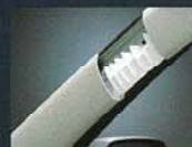
頭部衝撃緩和構造 (写真はSRSサイドエアバッグ+カーテンシールドエアバッグ (運転席・助手席) を装着しない場合です)
