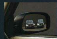
電動格納式リコンカロードアミラー (ヒーター付・運転席側ワイドビュー)
