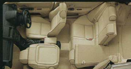
助手席前倒し+リヤシート片側前倒し状態+フラットデッキボード(高床状態)
