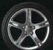
225/45ZR17 スチールラジアル (スーパークロムメタリック塗装 17×7J×5JJアルミホイール)
