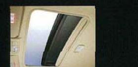
マイコン制御付スライド電動式パワーウィンドウ (ワンタッチ開閉・後み込み防止機構付)
