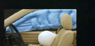
SRSサイドエアバッグ+カーテンシールドエアバッグ (運転席・助手席)
