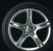
225/45ZR17 スチールラジアル (スーパーロームメタリック塗装 17X7JLAL1アルミホイール)
