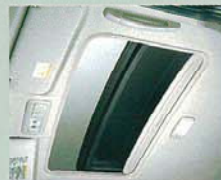
マイコン制御バルト&スライド電動式ムーンルーフ(ワンタッチ開閉・挟み込み防止機構付)
