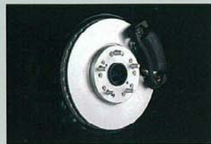
大径4輪ディスクブレーキ (写真はフロント)
