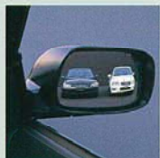
電動格納式リセコンカワードアミラー(運転席側ワイドビュー)
