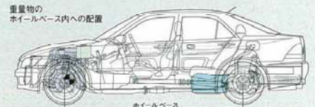
重量物のホイールベース内への配置 ●エンジンセンター □エンジン □バッテリー ■燃料タンク
