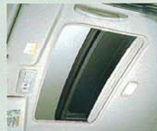
マイコン制御チルト&スライド電動式ムーンルーフ(ワンタッチ 開閉・挟み込み防止機構付)
