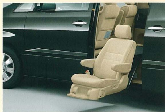
サイドリフトアップシート(電動)\* セカンドシート(キャプテンシート)左席に乗降をサポートする電動のサイドリフトアップシートを装着しました。昇降スイッチまたはワイヤレスリモコンを押し続けることによりシートをスライド・回転させた後、下降させる一連の動作を電動で行えるシステムです。またリクライニング・前後スライド調整も電動で操作することができます。
