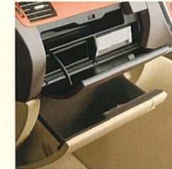
グローブボックス(上下二段式/写真は<シアターサウンドシステム>装着車)④
