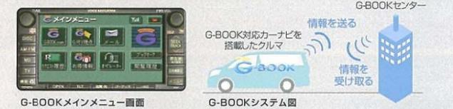
音声認識&音声読み上げ、ハンズフリー機能も充実。G-BOOKの操作はドライバーの音声でもOK。メールなどの文字情報も音声で読み上げてくれます。さらに、携帯電話を接続すれば、ハンズフリー通話も可能です。
