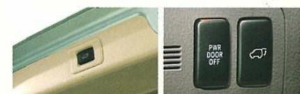
バックドアクローズスイッチ 室内コントロールスイッチ(インパネ部)
